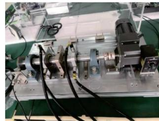
图 8 动车组滚动轴承故障模拟实验台
