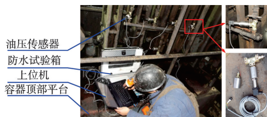
图12 多绳摩擦提升系统提升容器纵向振动测试
