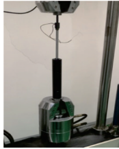
图1 磁流变阻尼器力学特性实验
