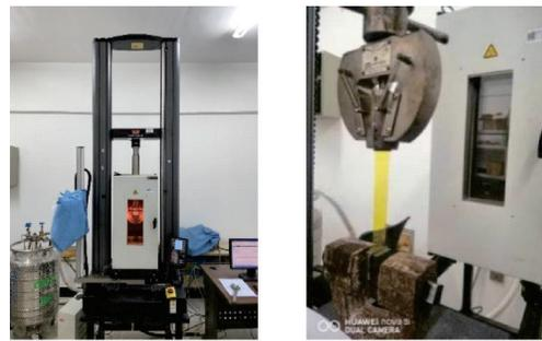
(a) 拉伸试验装置 (b) 手动楔形夹具
