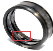
图 12 轴承外圈故障位置图
