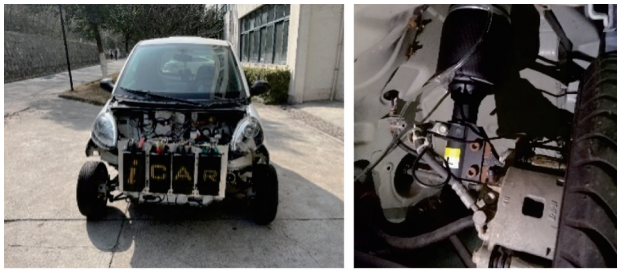
图 5 装有空气悬架的试验电动汽车
