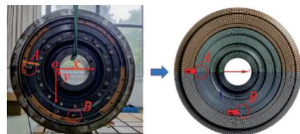
图8 结合有限元模型获取各测点坐标
