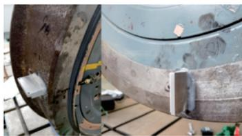
图9 铝制工装实物图
