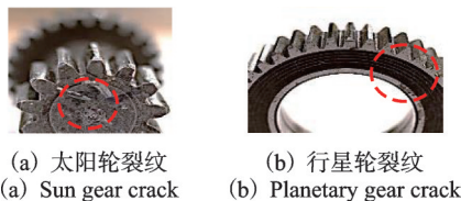
图7 齿轮故障件 Fig.7 Faulty parts of gear
