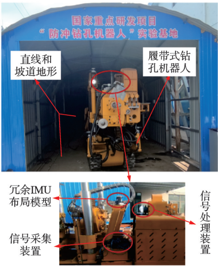
图 7 履带式钻孔机器人运动实验 Fig.7 Motion experiment of crawler drilling robot
