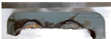
图 2 支架断口侧面宏观形貌
