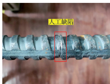
图7 具有人工缺陷的螺纹钢锚杆试样
