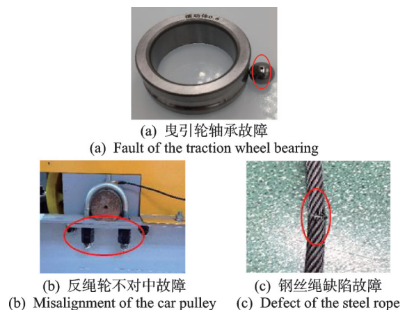
图3 曳引系统故障示意图
