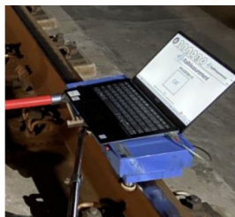
图 2 CAT 钢轨波磨测试系统
