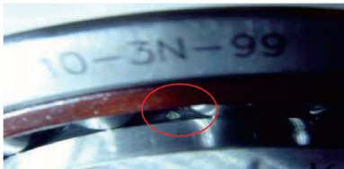
图4 H7018C型轴承内圈剥落图片
