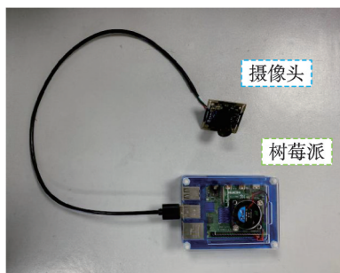
图 7 摄像头连接方式 Fig.7 Camera connection method
