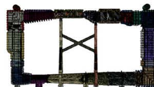
图1 水洞结构有限元模型
