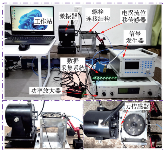
图 13 螺栓-盘连接结构激振实验台
