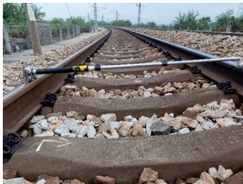
图1 钢轨型面跟踪测试现场
