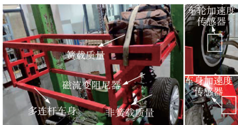
图8 1/4车半主动悬架试验台架
