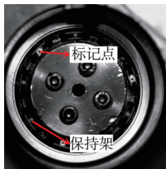
图 8 保持架表面标记点的运动图像
