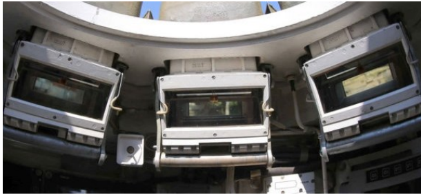
图 1 俄罗斯新型高速履带车辆车长潜望镜 [9]
