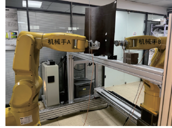
图11 双机械手穿透超声检测系统
