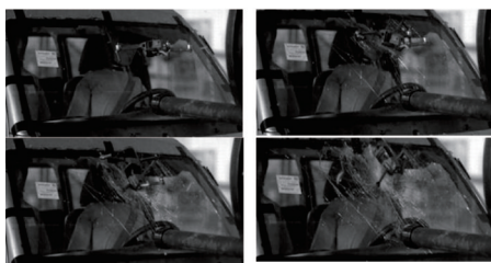
图6 无人机以30 m/s速度撞击未贴膜汽车前风挡玻璃试验过程
