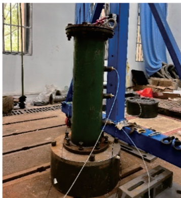
图 20 竖置式声阻抗测量装置
